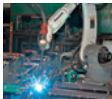
ロボット溶接
