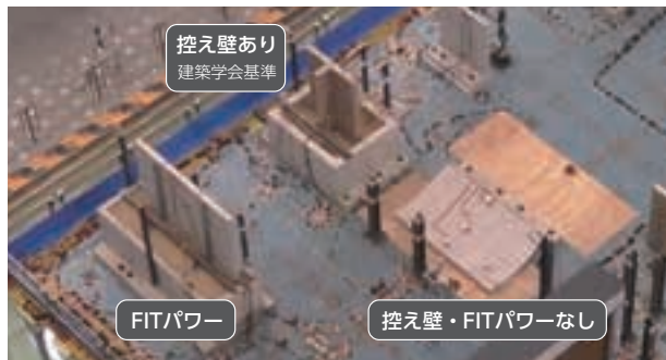
建設省告示に定められた模擬地震動加振後の状況
