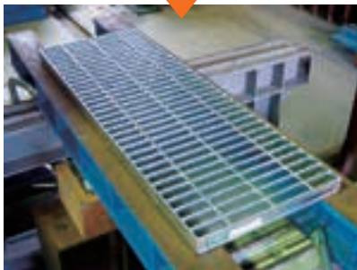
荷重試験後の状況
