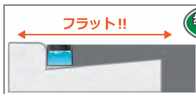
既設L型街渠+ドレンクリエイター
