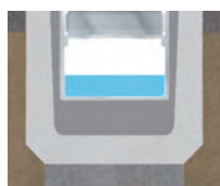
既設側溝利用
