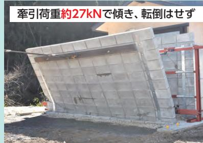
牽引荷重約27kNで傾き、転倒はせず
