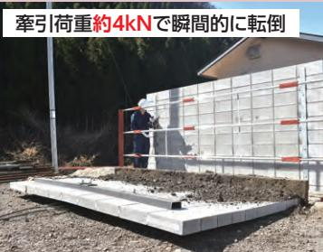
牽引荷重約4kNで瞬間に転倒
