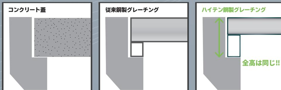
ハイテン鋼製グレーチングは、従来の鋼製グレーチングと同一荷重条件でも断面図は変わりません。
