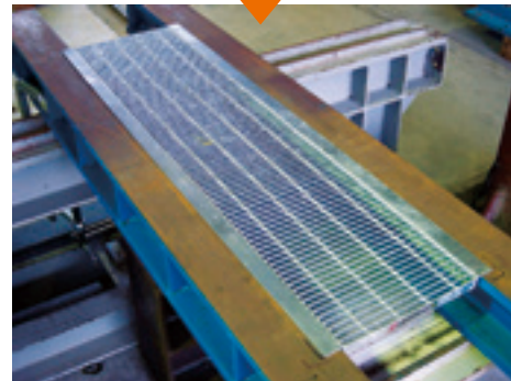
荷重試験後の状況
