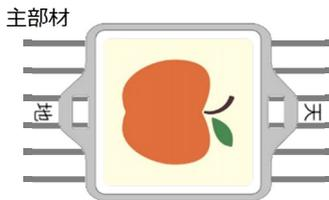
新設用デコレーショングレーチングはデコレーションプレートを溶接固定した状態で出荷いたします。また、既設用後付けデコレーションは取り付ける向きがあるためデザインの天地をご指定下さい。
